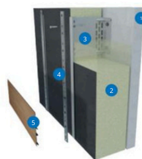
C Konsoles stiprinājums SEMS-AGS (minerālvate)
